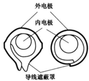
f) 软质导线耐压试验外电极
